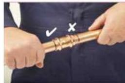
Remettre le tube en butée avant de presser
