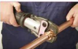
Positionner correctement les mâchoires sur le raccord
