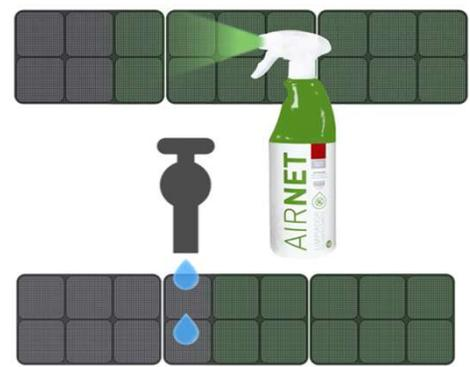
**ETAPE 6** Finir le nettoyage et l'entretien par la désinfection en vaporisant AIRPUR sur l'échangeur.
